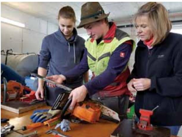
Foto: Reinigen, Ketten spannen und schleifen bzw. feilen führte jede Teilnehmerin nach Anweisung selbst an Ihrer Motorsäge durch
