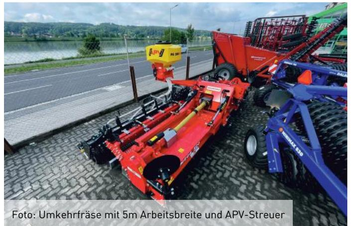
Foto: Umkehrfräse mit 5m Arbeitsbreite und APV-Streuer
