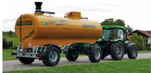
9m<sup>3</sup> Zunhammer-Pumpfass mit geringem Eigengewicht, Schleppschuhverteiler AB 12m, Bordhydraulik, Endabschaltung, Bereifung 850/50R 30, Untenanhängung, 13to.
