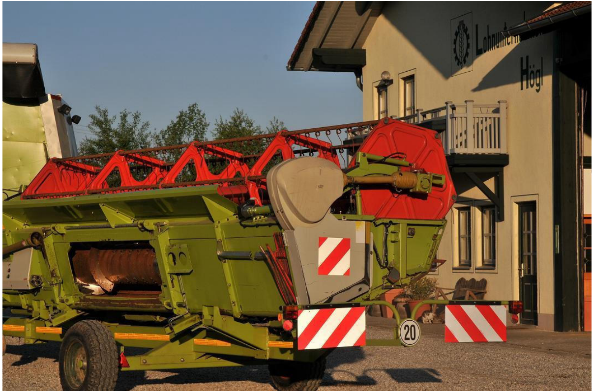
Das Bild zeigt die gelben Seitenreflektoren sowie die Heckmarkierungstafeln am angehängten Mähwerk
